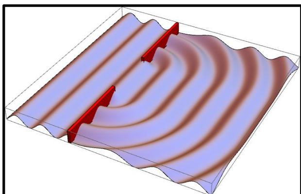
Beugung einer ebenen Welle an einem breiten Spalt:
