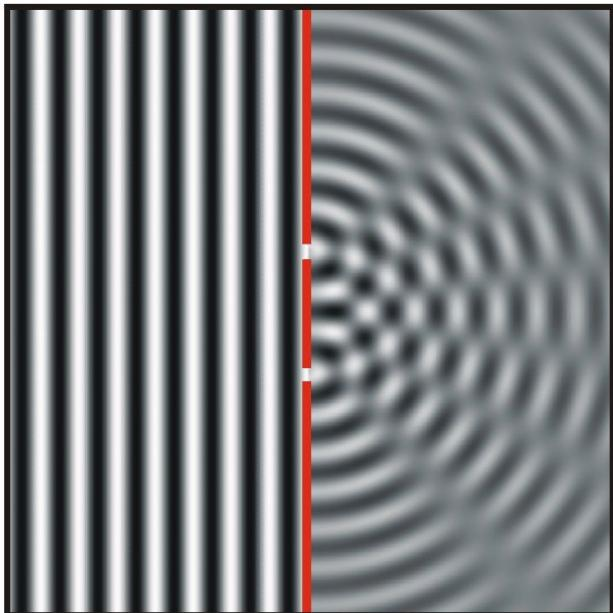
Beugung einer ebenen Welle an zwei Spalten:
